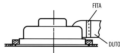
**4 - Ligue o produto e verifique seu funcionamento. Instale a grelha comprimindo a presilha e inserindo-a na fenda para o encaixe da mesma.**
