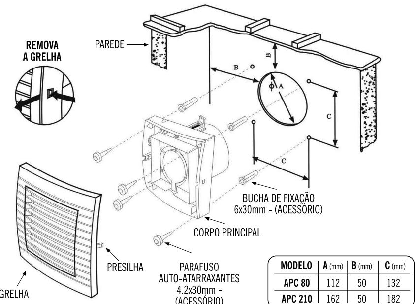
01. Faça o furo principal na parede para passagem do tubo do exaustor, conforme medidas indicadas acima;
